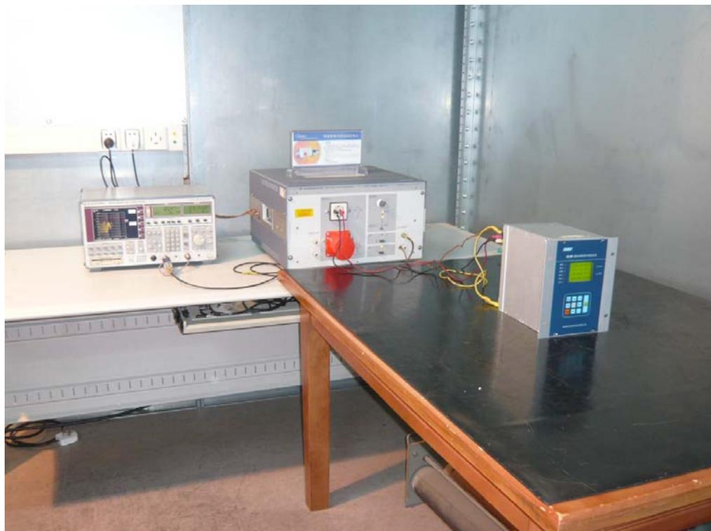
图 8: 传导发射限值检验配置图
