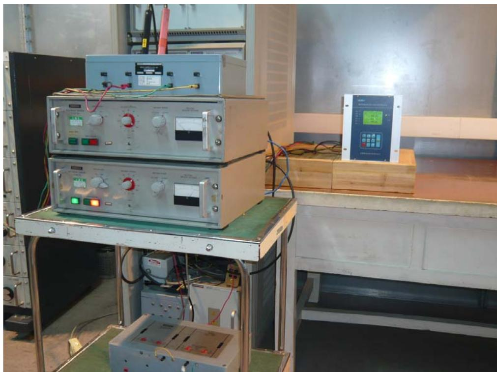
图 1: 振荡波抗扰度检验配置图
