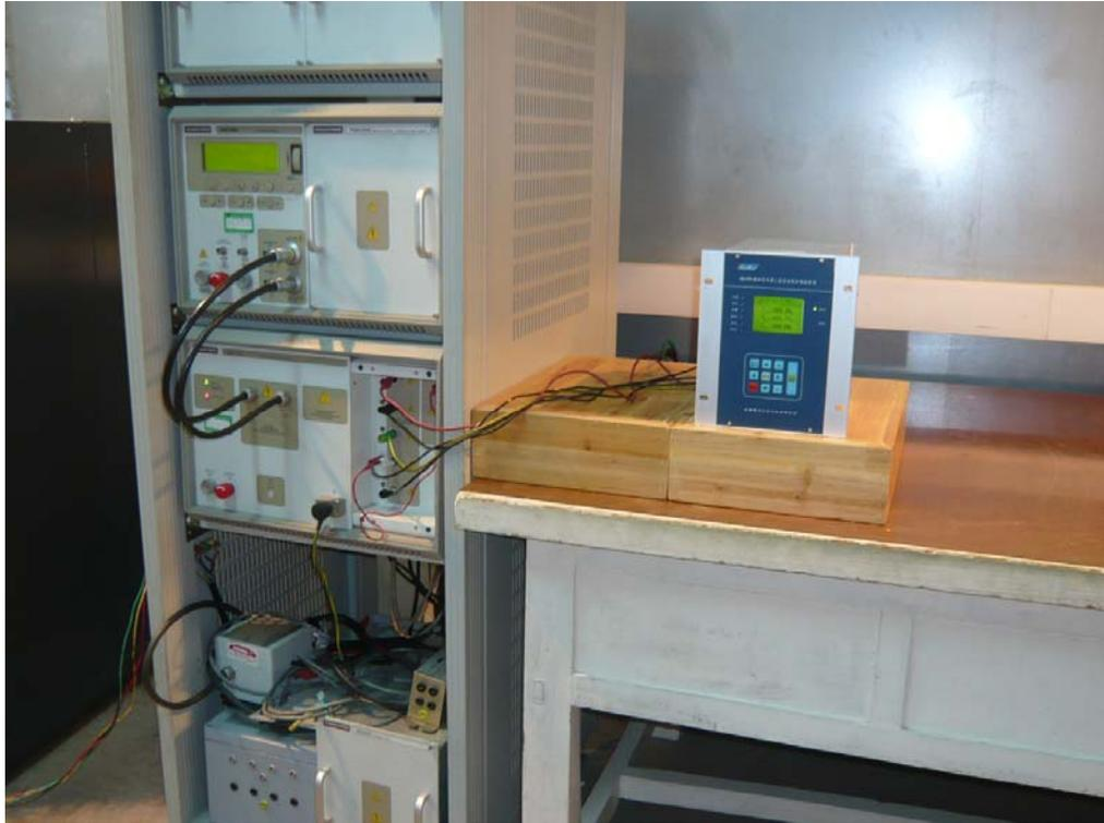
图 5: 浪涌抗扰度检验配置图
